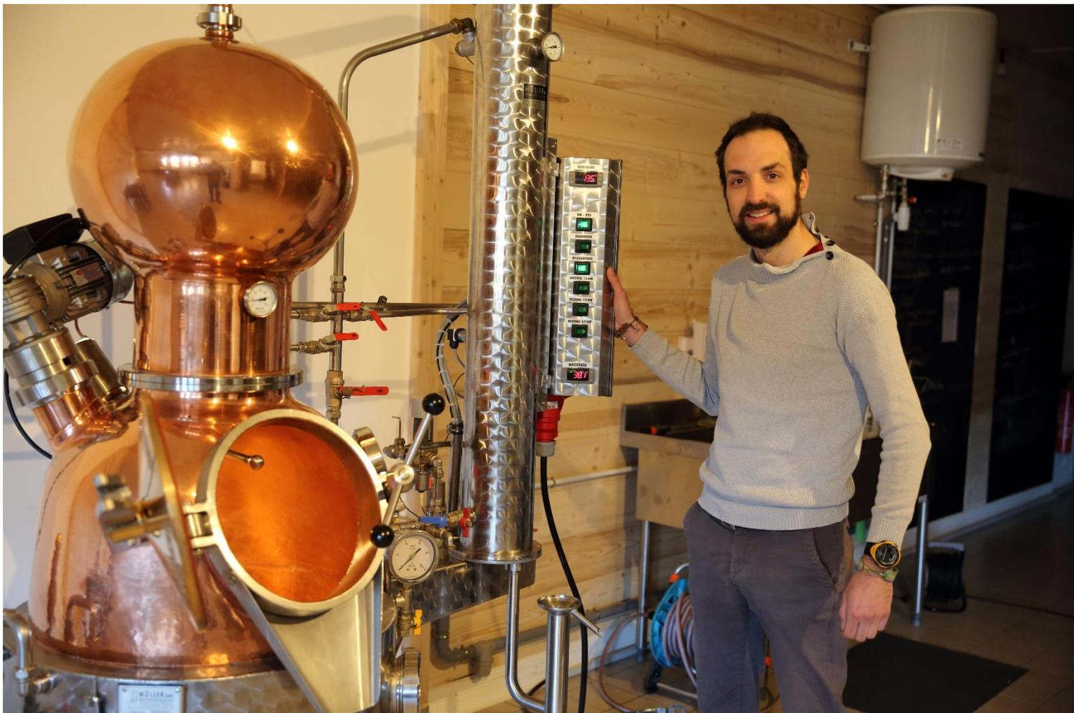
Distillation de type Charentaise. Un autre distillateur actuellement en construction arrivera prochainement, il sera équipé d'une colonne pour des usages bien spécifiques.
