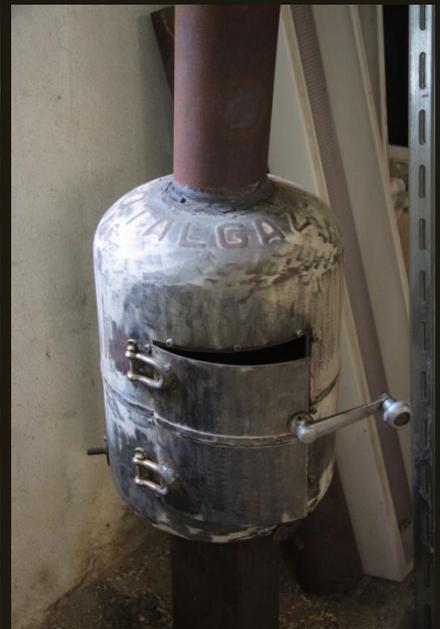
Le fils aîné de Maël, Mimik ici présent a commencé un long et bel apprentissage de charpentier chez les compagnons du devoir. A droite la réutilisation d'une vieille bouteille de gaz, transformée en poêle idéal pour le chauffage au bois.
