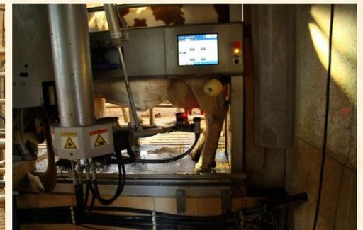
La machine automatique détecte les pis et s'occupe seule des diverses opérations, nettoyage, traite etc...
