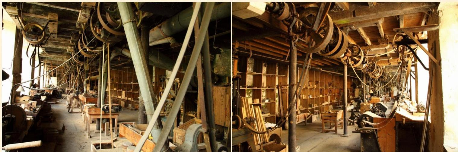
Autre belle découverte, nous sommes dans des ateliers du XIX<sup>ème</sup> siècle où les machines étaient entraînées par la force hydraulique, puis par des arbres et des poulies.
