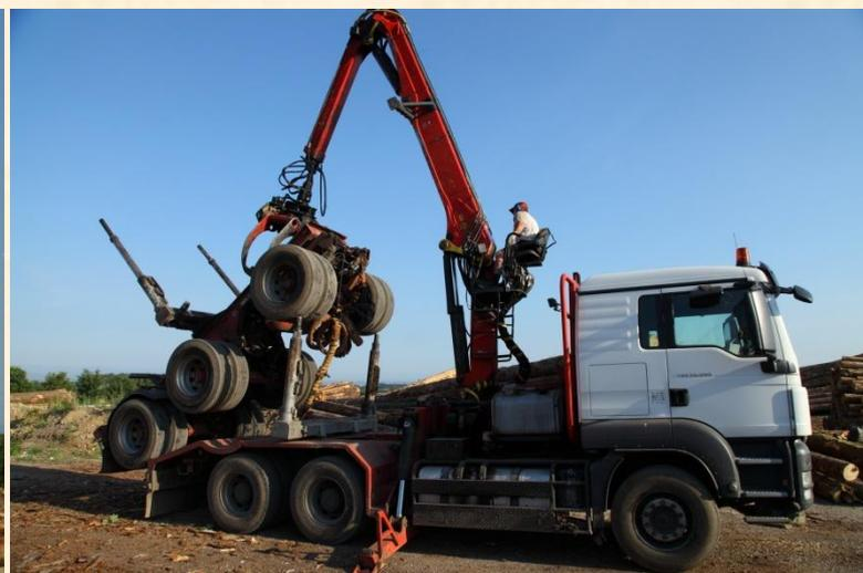
Les astuces du grumier : une tronçonneuse sur les griffes permet de rectifier les erreurs de la nature, la grue est prévue pour monter et placer la remorque sur le tracteur.
