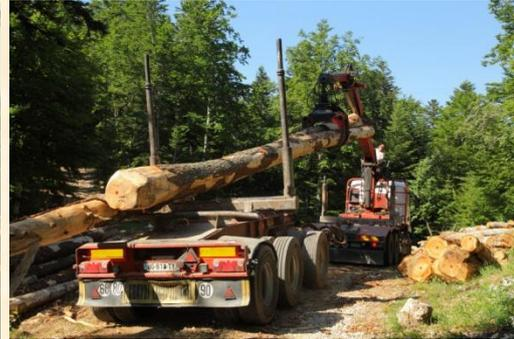
Déchargement de la remorque, mise en ligne de celle-ci avec une grume et chargement des autres grumes.
