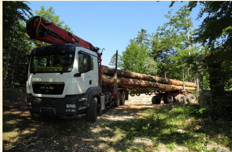
Autre astuce de l'attelage : la remorque dispose d'une direction comme un véhicule indépendant, le système est piloté depuis la cabine et fonctionne jusqu'à une vitesse maximale de 20 km/h, ce qui permet au grumier les manœuvres les plus improbables sur des chemin forestiers, avec parfois de fortes déclivités.
