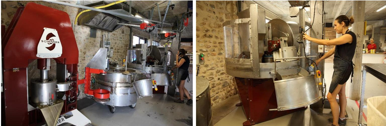
Deuxième opération entre deux coups de téléphone, changer de machine, les cerneaux écrasés vont être chauffés entre 105 et 115 °C (Chaque production sera chauffée en fonction des souhaits du client, c'est parfois plus, c'est parfois moins).
