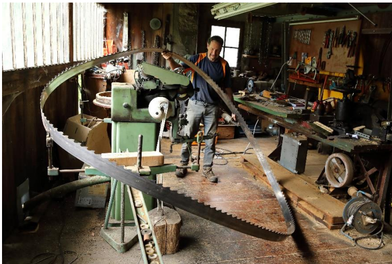
2 ème phase : Placer la lame récalcitrante sur l'affuteuse.
